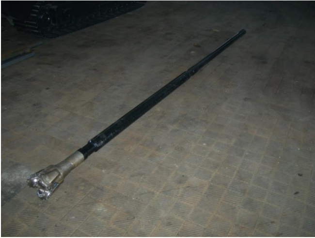
Na zdjęciu po lewej świder 3-gryzowy 150 mm, rura super ciężka i rura standardowa.
