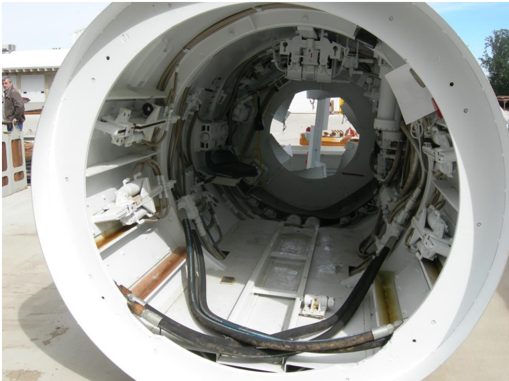
Maszyna TBM-1600 od środka (sprzedana przez firmę Marpol w 2003 roku)
