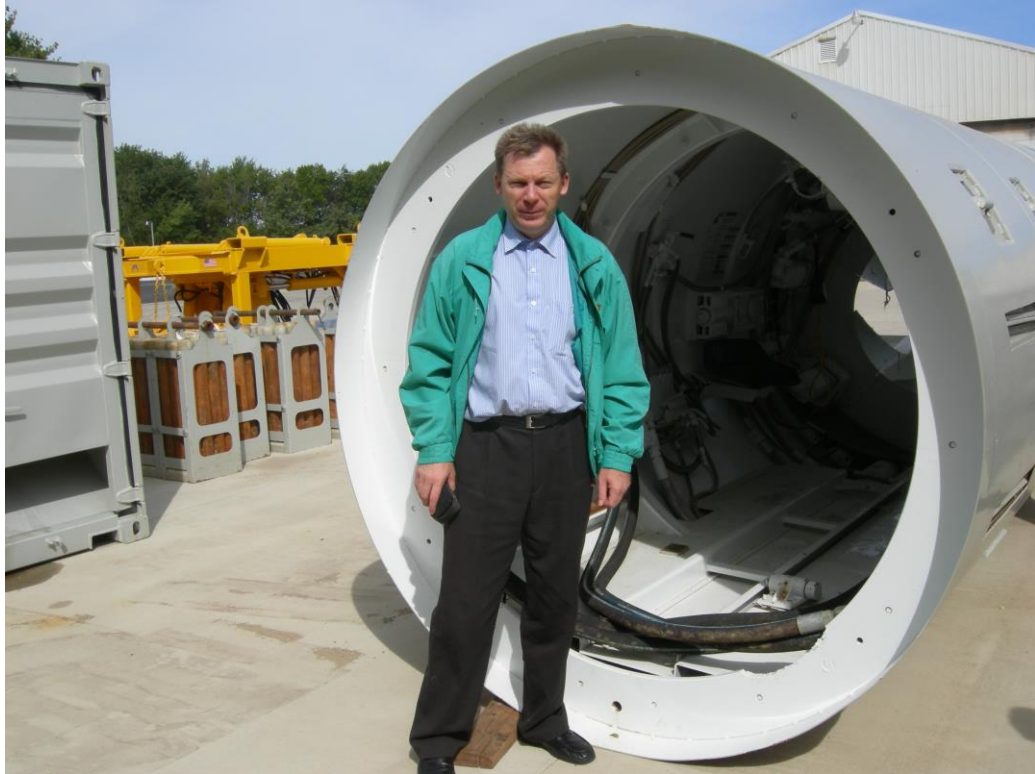
Autor opracowania na tle sprzedanej maszyny TBM 1600 mm (maszyna TBM ma długość około 5 m, masę około 6-10 ton)
