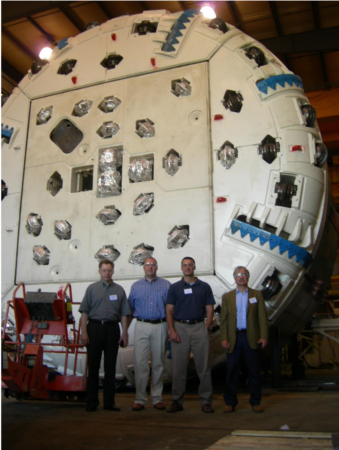
Maszyna TBM o dużej średnicy do tunelowania w skałach (tunele o średnicy do 15 m)
