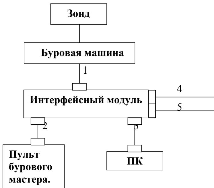
1- Кабель SNS 100.001V.0; 2- кабель SNS 100.001V.02; 3- кабель SNS 100.002V.02; 4- кабель SNS 100.003V.02 используется при питании от сети 220В.; 5- кабель SNS 100.004V.02 используется при питании от 12В.
